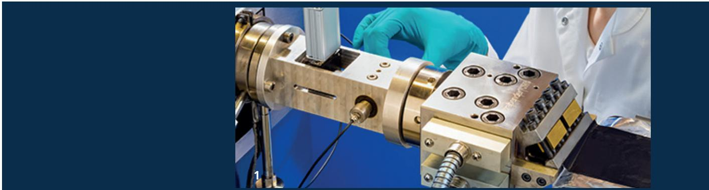
1 Der Durchfluss-Sensor vereint mechanische (Ultraschall) und elektrische (Induktive Impedanzspektroskopie) Messverfahren – und kann so eine Vielzahl an Parametern in durchströmenden Fluiden bestimmen.
